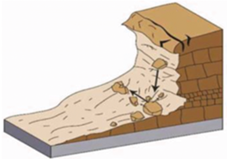
Figura 6. Esquema de una caída de rocas tipo desprendimiento Adaptado de Highland y Bobrowsky (2008).
