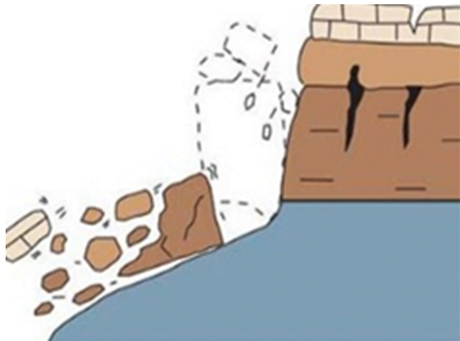
Figura 9. Esquema de una caída de rocas tipo volcamiento Adaptado de Highland y Bobrowsky (2008).
